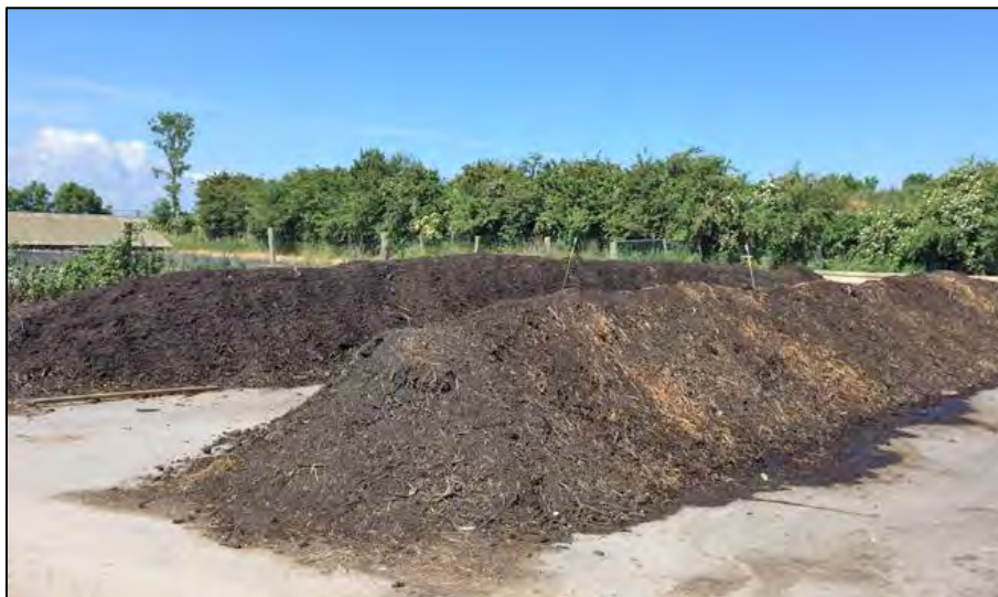
Илустрација 6-17: Изглед система за компостирање са отвореним линијски обликованим гомилама (извор: compost-system.com)
